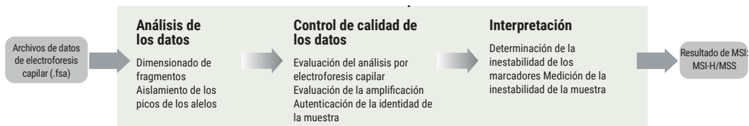
Figura 5. Flujo de trabajo para analizar los datos de la electroforesis capilar del OncoMate™ MSI Dx Analysis System.
