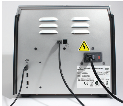
Figure 12. Raccordez la tablette à l'arrière du Maxwell® CSC Instrument.
