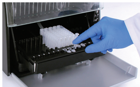
Figure 48. Fermeture des bouchons des tubes d'élution.
