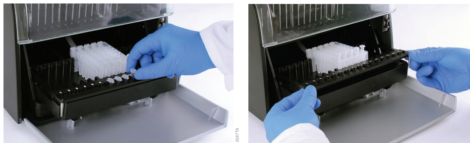
Figure 49. Retrait des tubes d'élution et du portoir de la plateforme.
