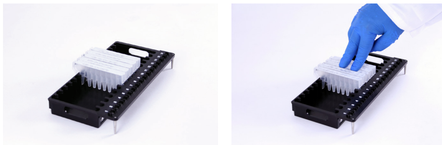
Figure 43. Placez les cartouches dans le portoir de la plateforme et appuyez fermement pour les mettre en place.
