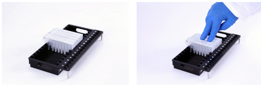
Bild 43. Placera patronerna i trågbrickan och tryck till bestämt så att de kommer på plats.
