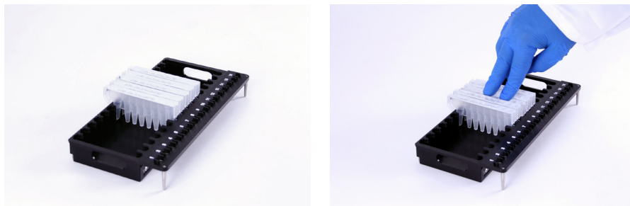
Figura 43. Coloque os cartuchos no tabuleiro da plataforma e pressione firmemente para os encaixar na respetiva posição.
