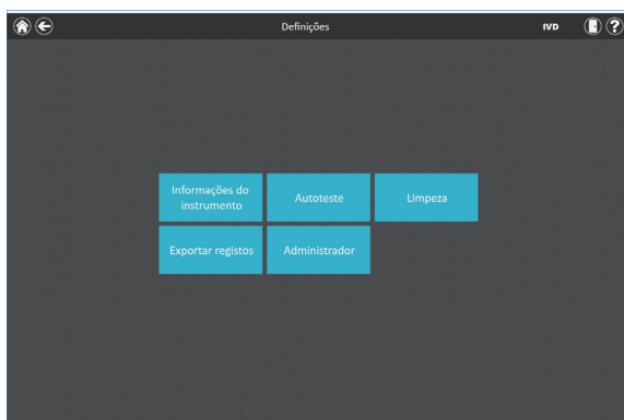
Figura 21. Ecrã "Definições" do Maxwell® CSC. A partir deste ecrã pode realizar um procedimento de limpeza para descarregar quaisquer êmbolos ainda existentes na barra de êmbolos após uma execução do protocolo mal sucedida.
