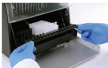
Εικόνα 49. Αφαίρεση σωληναρίων έκπλυσης και δίσκου πλατφόρμας.
