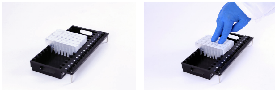
Εικόνα 43. Τοποθετήστε τα φυσιγγία στο δίσκο πλατφόρμας και πατήστε μέχρι να ασφαλίσουν στη θέση τους.
