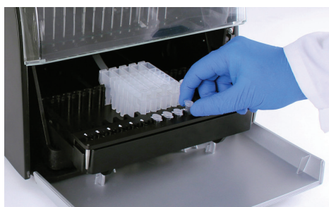
Εικόνα 49. Αφαίρεση σωληναρίων έκπλυσης και δίσκου πλατφόρμας.
