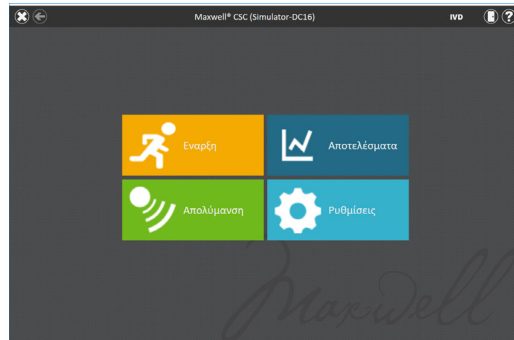
Εικόνα 56. 'Αρχική' οθόνη Maxwell® CSC. Επιλέγοντας Αποτελέσματα ανοίγει η οθόνη 'Αποτελέσματα' του Maxwell® CSC όπου μπορείτε να προβάλετε αναφορές εξαγωγής από όλες τις εκτελέσεις εξαγωγής, τις δραστηριότητες συντήρησης και τις δραστηριότητες του συστήματος.
